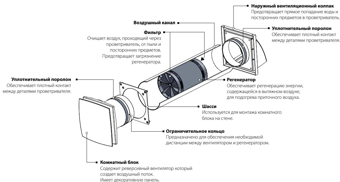
Проветриватель работает в два цикла по 60 секунд.
