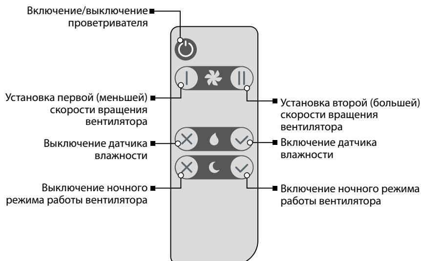
При включении с помощью кнопки **Включение/выключение** на пульте дистанционного управления проветриватель начинает работать на той скорости, при которой он был выключен.
